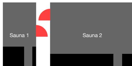
**Abbildung 2:** *Vorschlag zum Einbau.* Nach außen öffnende Fenster mit abnehmbarem Griff erscheinen am geeignetsten. Diese sollten in Fluchrichtung zu schließen sein.
